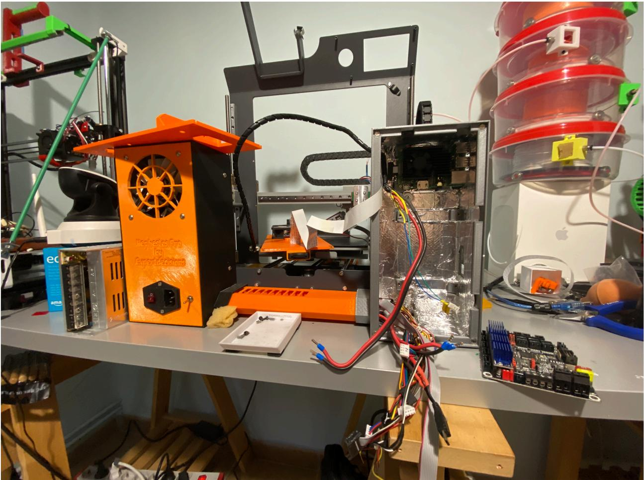
La fuente de alimentación ya montada y cerrada y la caja de la electrónica con los cables pasados, la Raspberry Pi instalada y preparada para recibir la SKR 1.3
